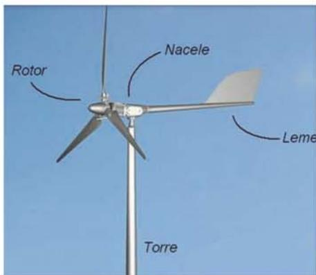
Figura 2: Aerogerador de pequeno porte e seus componentes.
